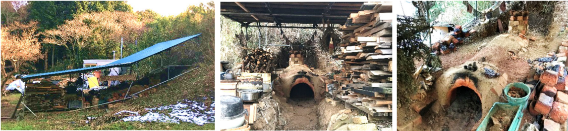
・取手の土で作られた穴窯。学生や教員からは「むかで窯」という愛称で呼ばれている。
